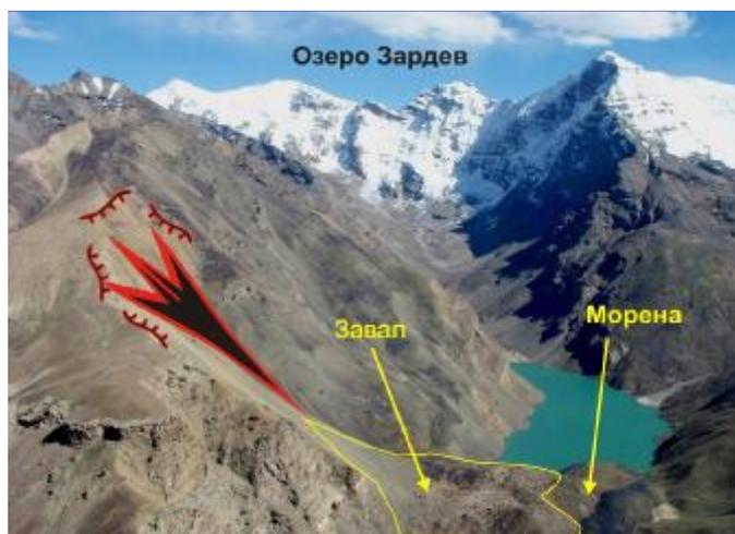
Фото 8. Композитная плотина оз.Зардев – долина р.Шахдара
