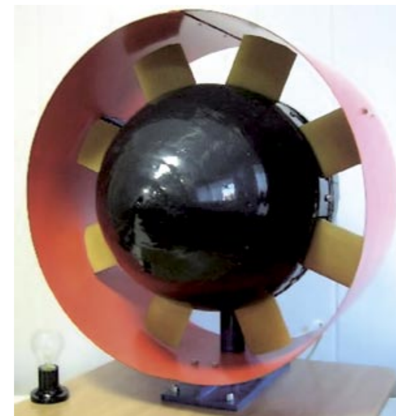
Рис. 2. Внешний вид турбогенератора микроГЭС "АкваТрон - 300"
