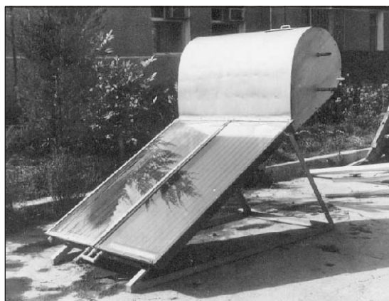
3.11. Опытный образец солнечной водонагревательной установки в НИИ Физ.-тех. АН РТ
