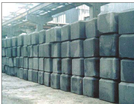
3.19. «Зелёные» аноды, изготовленные на ТадАЗе перед процессом обжига
